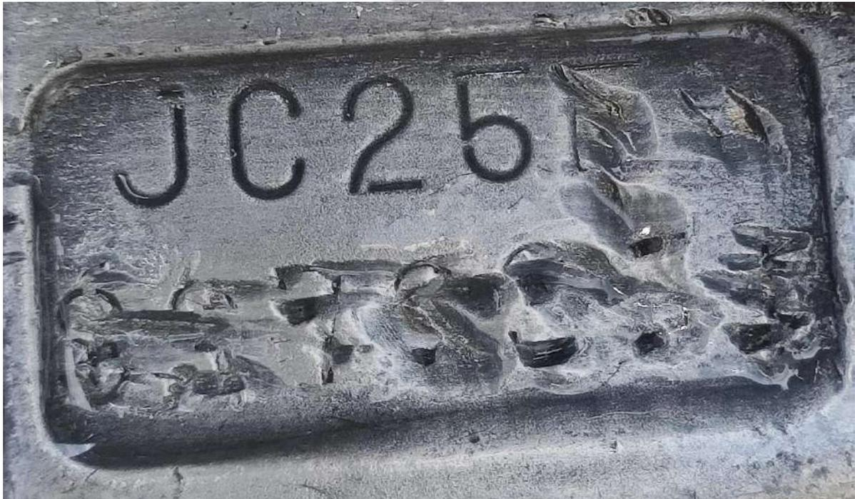
Fotografia ilustrativa 03 – Mostra detalhes do local da gravação da Sequência Alfanumérica Identificadora do motor e os danos ali observados.
