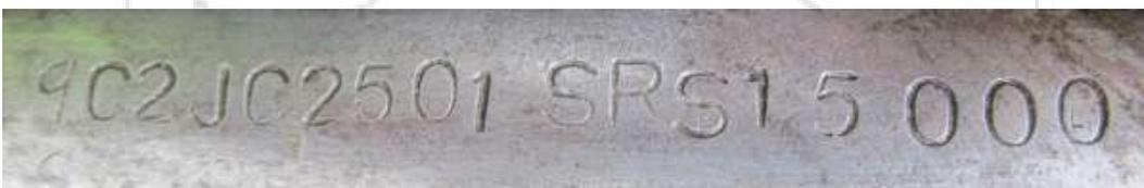
Fotografia ilustrativa de nº 02 – Mostra detalhes da gravação adulterada do NIV observado no veículo.
