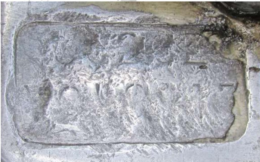
Fotografia ilustrativa de nº 03 – Mostra detalhes do local da gravação da Sequência Alfanumérica Identificadora do motor e os danos ali observados.
