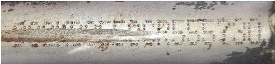
Fotografia ilustrativa 02 – Mostra detalhes do local e da gravação do NIV danificado.
